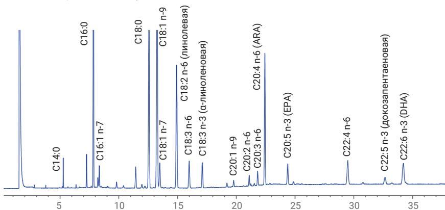
Пики метиловых эфиров эйкозапентаеновой, докозагексаеновой и других ключевых омега-3 и омега-6 полиненасыщенных жирных кислот животного происхождения разрешаются до базовой линии.
