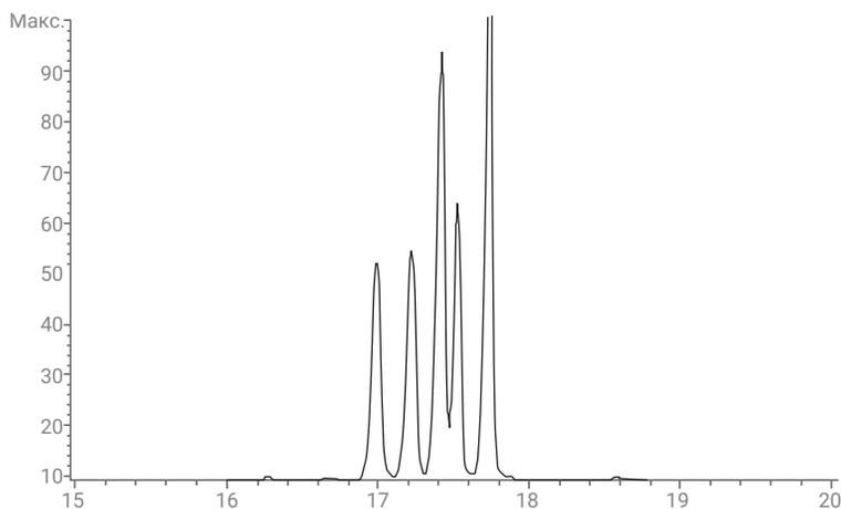
Колонка Agilent HP-88 позволяет за 50 минут разделить 16 метиловых эфиров сопряженных линолевых кислот.
