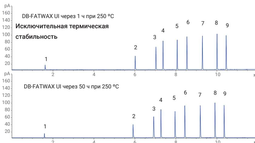
Хроматограмма короткоцепочечных летучих органических кислот (C1–C6) на колонке DB-FATWAX Ultra Inert после кондиционирования при 250 °C в течение 1,5 ч.
