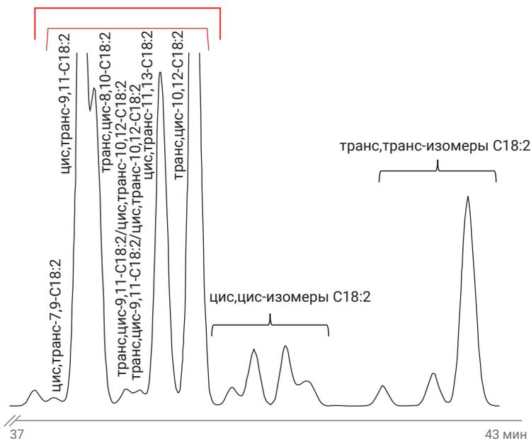
Лучшая колонка для разделения и количественного определения изомеров сопряженных линолевых кислот в сложных смесях.
