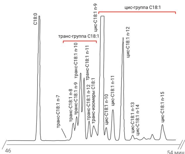
Лучшая колонка для самого детального анализа позиционных цис/транс-изомерных МЭЖК.
